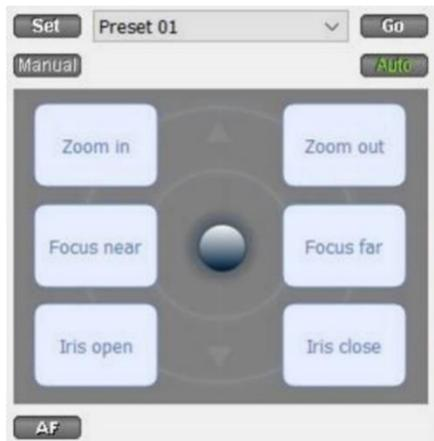
Mit einer PTZ-Kamera ("Schwenk-Neige-Zoom") kann der Bediener die Richtung der Kamera, den Zoom, die Brennweite (Fokus) und die Lichtmenge (Blende) beeinflussen.
