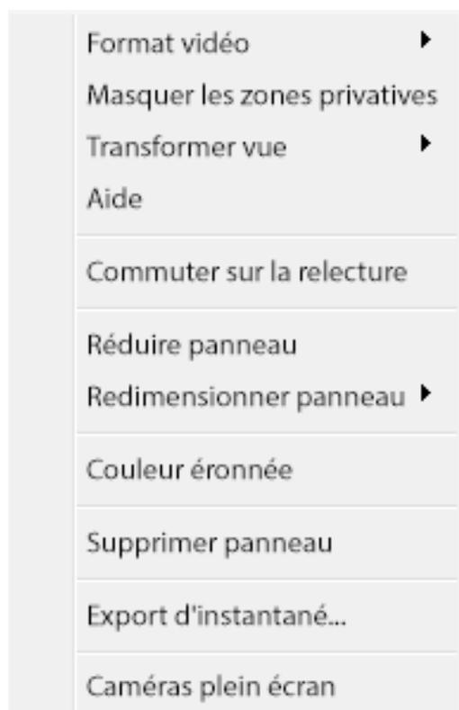
**Format vidéo:** Permet à l'utilisateur de sélectionner les flux vidéo de la caméra qu'il souhaite visualiser, et dans quel format/résolution.
