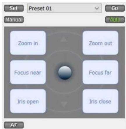
Avec une caméra Panoramique, Inclinaison et Zoom (PTZ), un opérateur peut manipuler la direction de la caméra, le Zoom, la Distance Focale (Focus) et la quantité de lumière (Iris).
